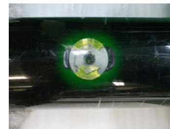
室内での注入試験 (アクリル管内でウラニンを放出)
