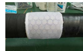
吐出口の周囲に並べたスペーサーを メッシュで固定して試験区間を構築
